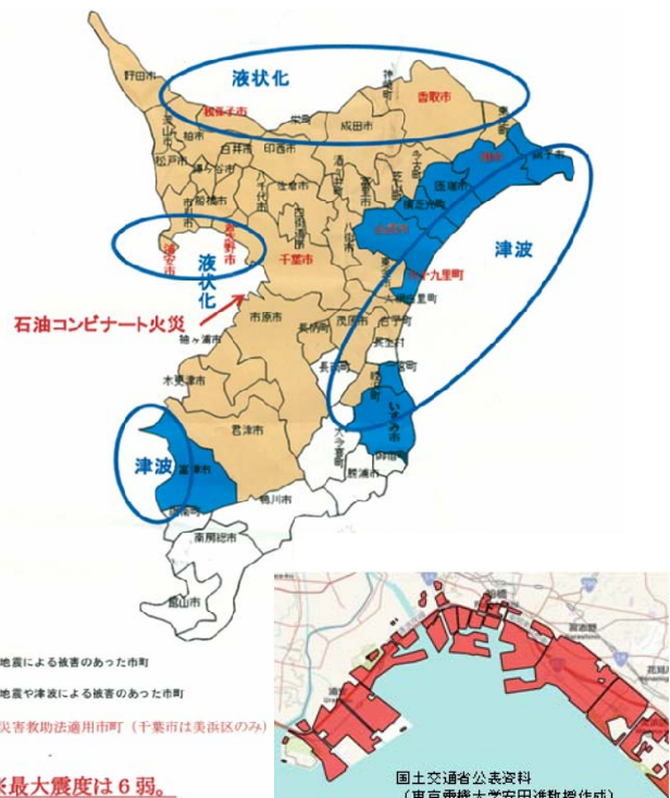
図2 千葉県の被災状況(千葉県公表資料)と臨海部液状化エリア
